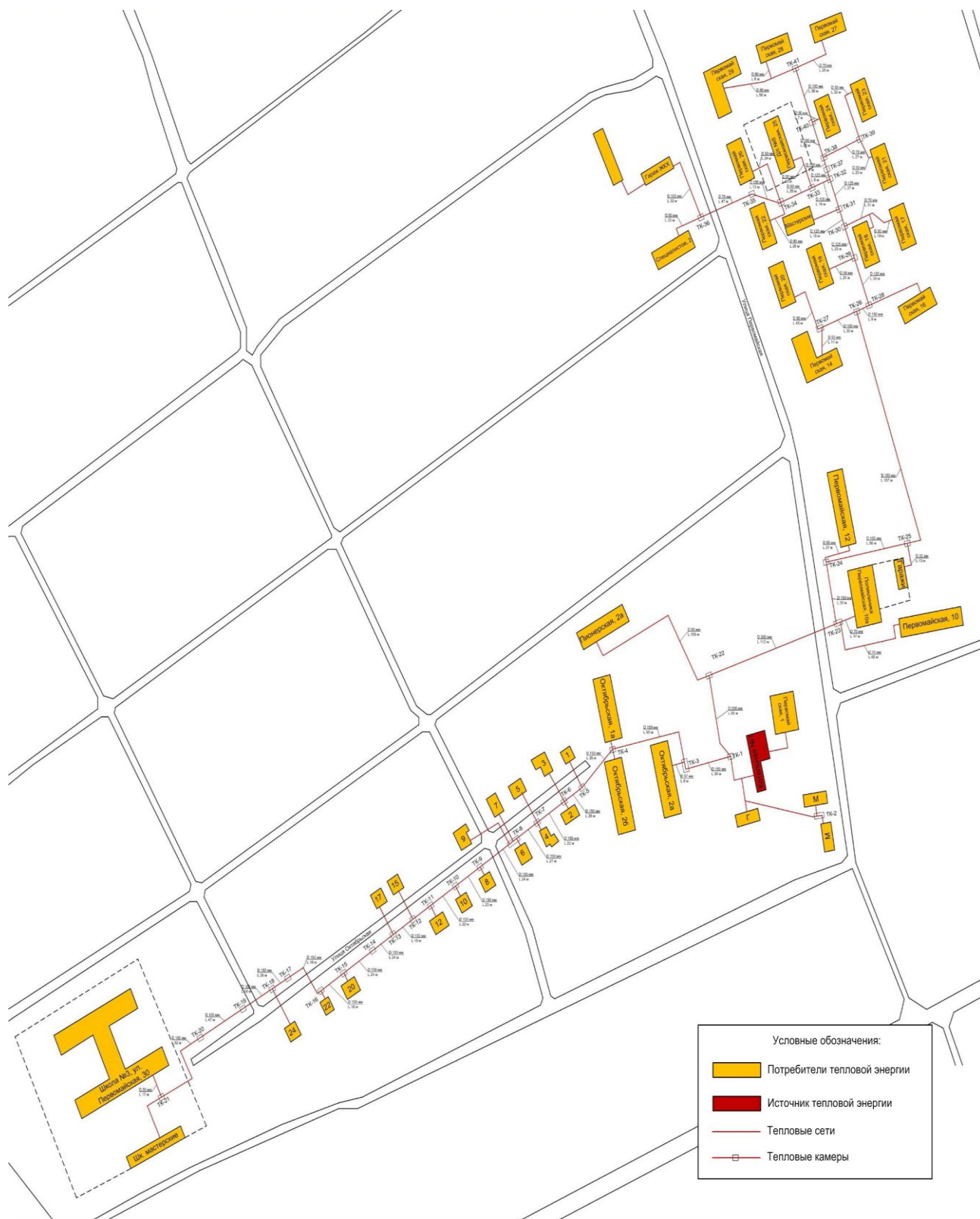
Рисунок 1.3.2.1 – Схема тепловых сетей котельной №1 (г.п. Смышляевка, ул. Октябрьская, 1а)
