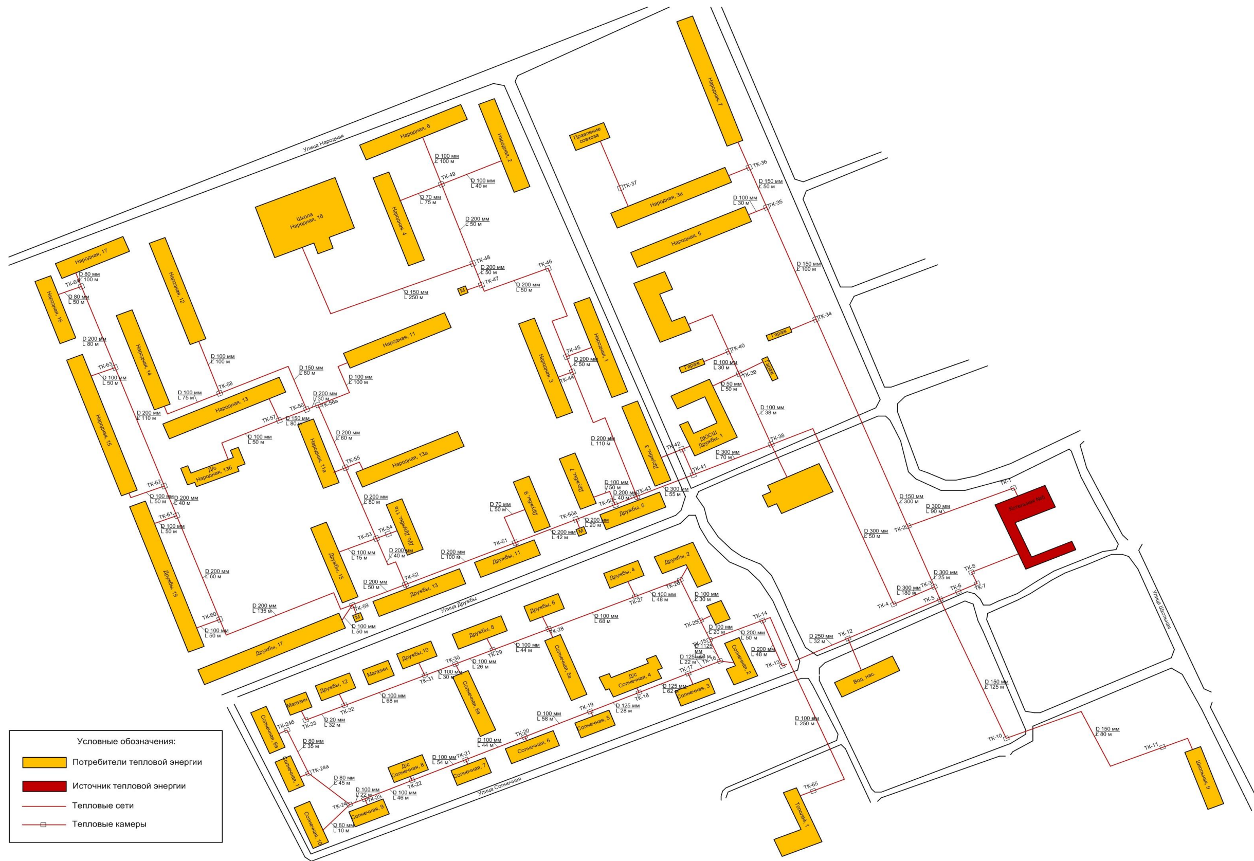
Рисунок 1.3.2.5– Схема тепловых сетей котельной №5 (п.г.т. Стройкерамика, ул. Спортивная, 45а)
